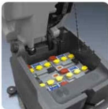
Grande autonomia grazie a 4 batterie da 6V 240Ah di elevata capacità che garantiscono tempi di lavoro in continuo fino a 4,5 h. Possibilità di montare anche 2 batterie da 12V. Minori consumi grazie alla trazione posteriore. Serbatoi in polietilene ad alta resistenza agli urti e agli acidi e di ampia capacità [85 l. reali], che evita frequenti soste per il riempimento.
